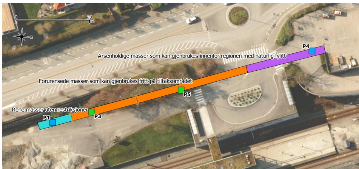
Figur 4. Anbefalt massehåndtering basert på forurensningsgraden til massene.
