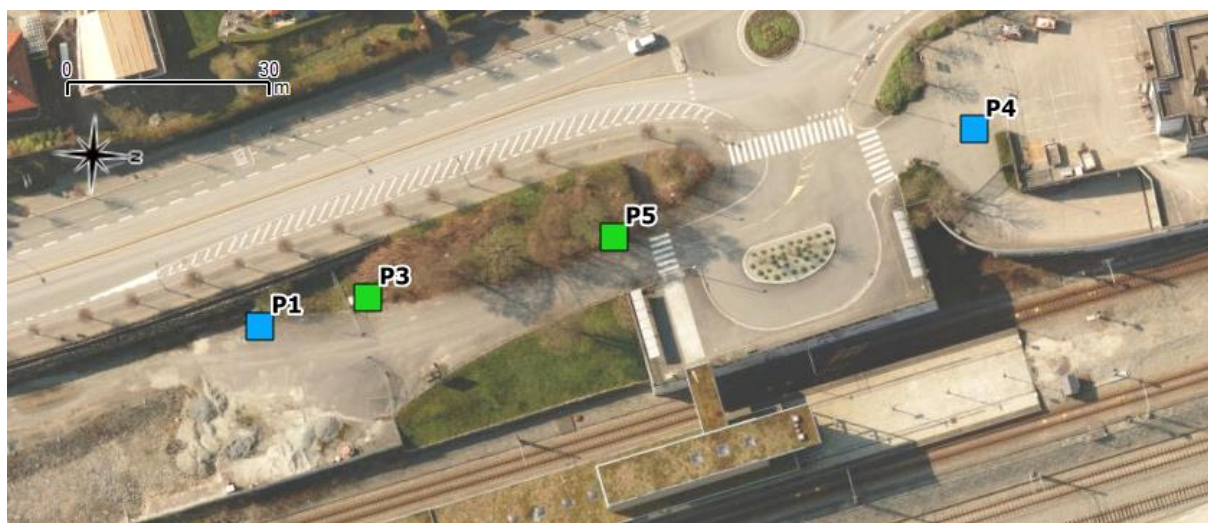
Figur 2. Høyeste påviste tilstandsklasse (etter TA-2553 (2009)) for prøvene tilknyttet punkt P1, P3, P4 og P5 etter at arsenkonsentrasjonen er justert til Stavanger kommunes bakgrunnsverdi. Blå er tilstandsklasse 1 (bakgrunn), grønn er tilstandsklasse 2 (god).
